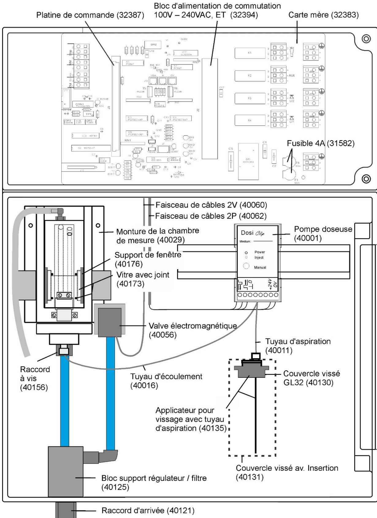
**Bloc support régulateur / filtre avec tuyauterie**
